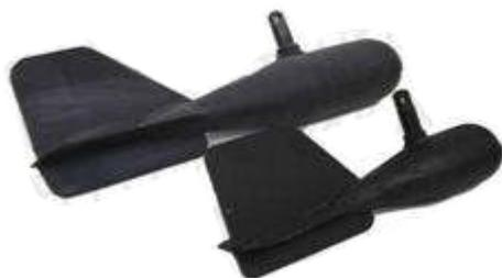
Гидрометрические грузы «ГГР» предназначены для уменьшения отклонения троса от вертикали при определении расходов воды и проведения других гидрометрических работ. Грузы ГГР выпускаются массой 5кг, 10кг, 15кг, 25кг.
